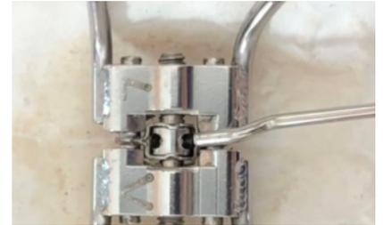
3) Pousser alors cette clé vers l'arrière dans le sens de la flèche et jusqu'à la butée.
